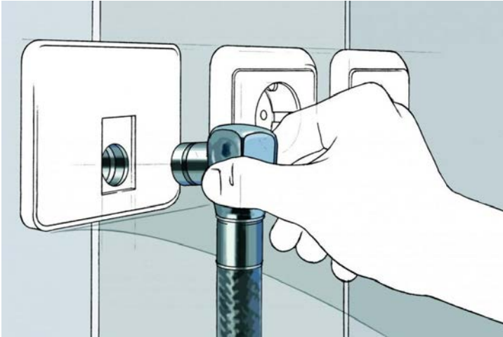
Gas-Steckdose und Gasschlauchleitung ©DVGW
